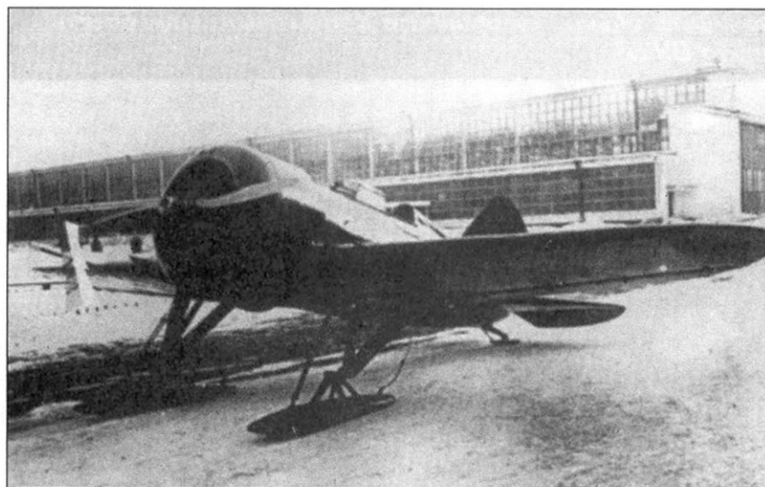
Второй прототип ЦКБ-12бис с двигателем Райт «Циклон» F-3, февраль 1934 г.
