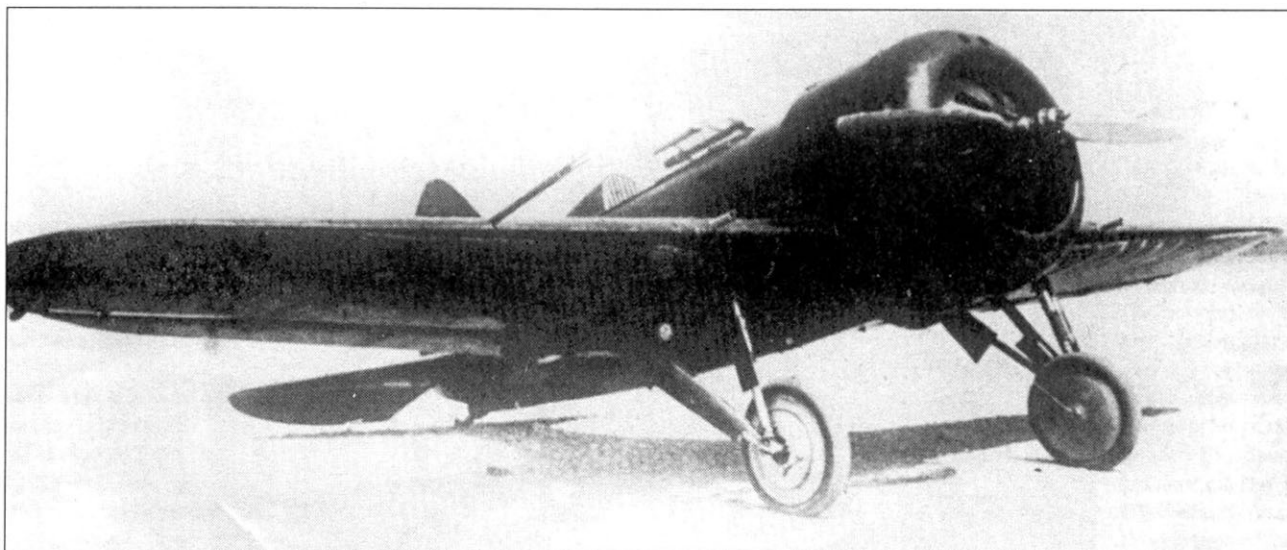
Серийный выпуск первой модификации истребителя И-16 с двигателем М-22 начался в 1934 г. В течение двух лет было построено несколько сотен таких истребителей.
